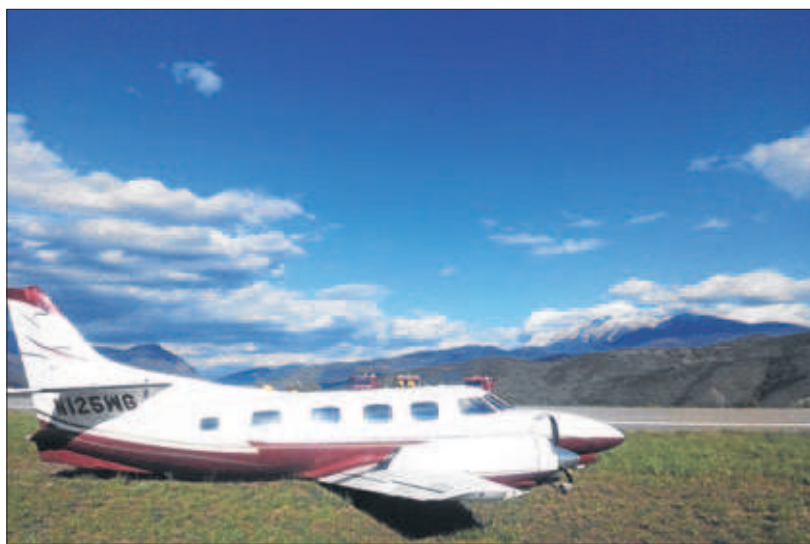
L'avió va aterrar sense el tren d'aterratge i les hèlixs es van doblegar.
