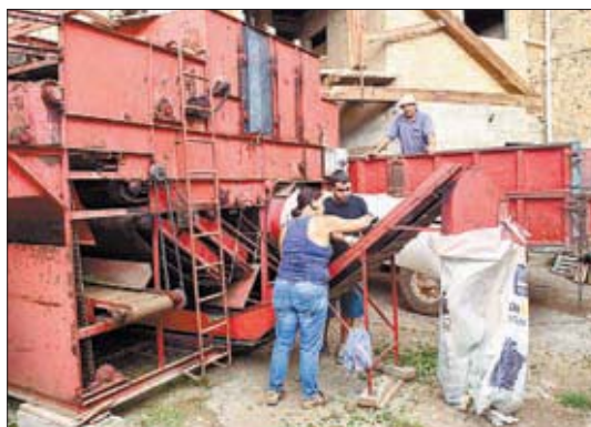
FOTO: Catalana de Llúpul / Màquina que fa la tria de les fulles del llúpul
