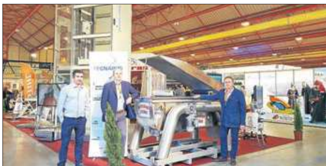
SALLERAS HERMANOS presenta com a novetat el sistema de gestió de purins a la granja, separador de sòlid-líquid TP-01 Tecnapur, amb un consum inferior a 0,5 kW/h capaç de separar la matèria sense utilitzar bombes trituradores.
