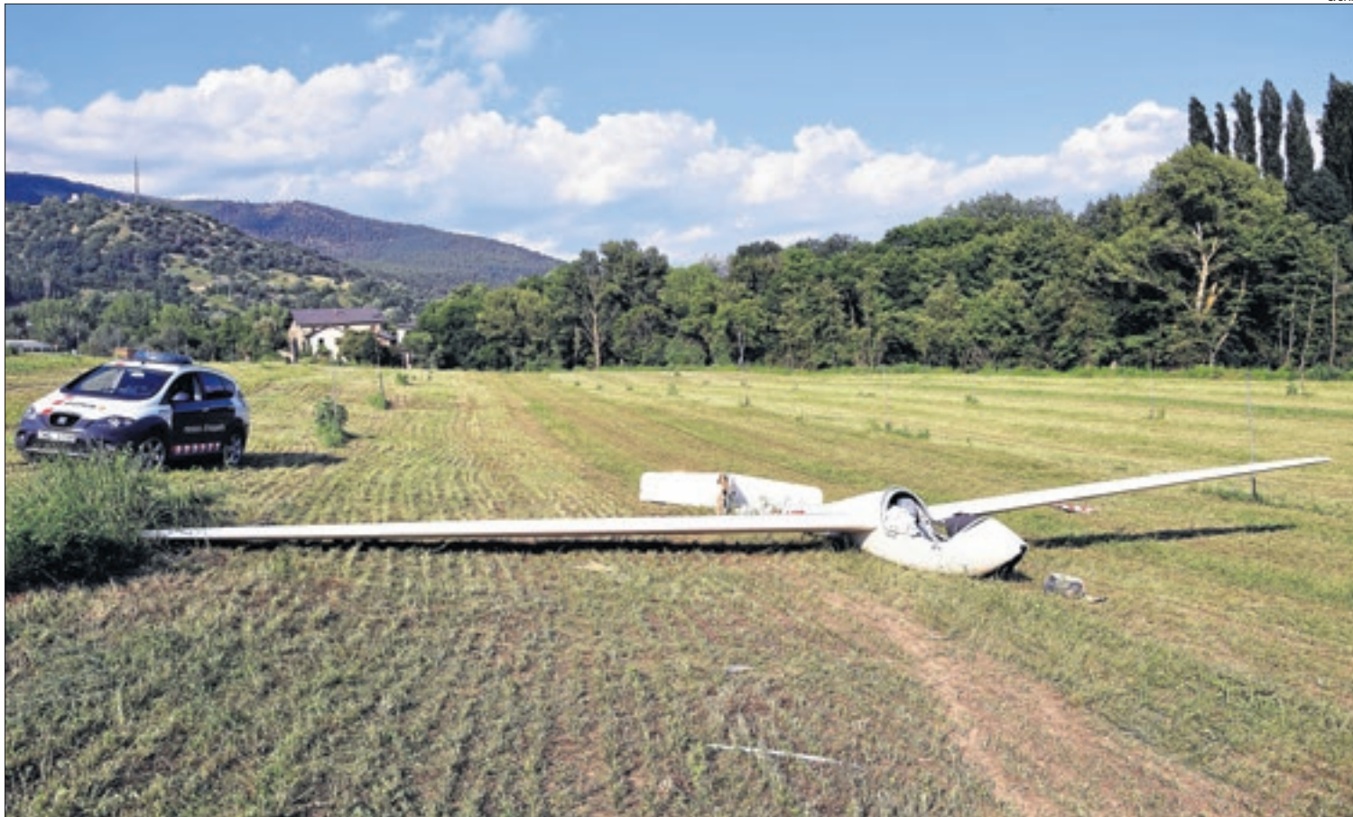
Estat en el qual va quedar el planador després d'impactar contra el camp, amb una roda i la cua arrancades.
