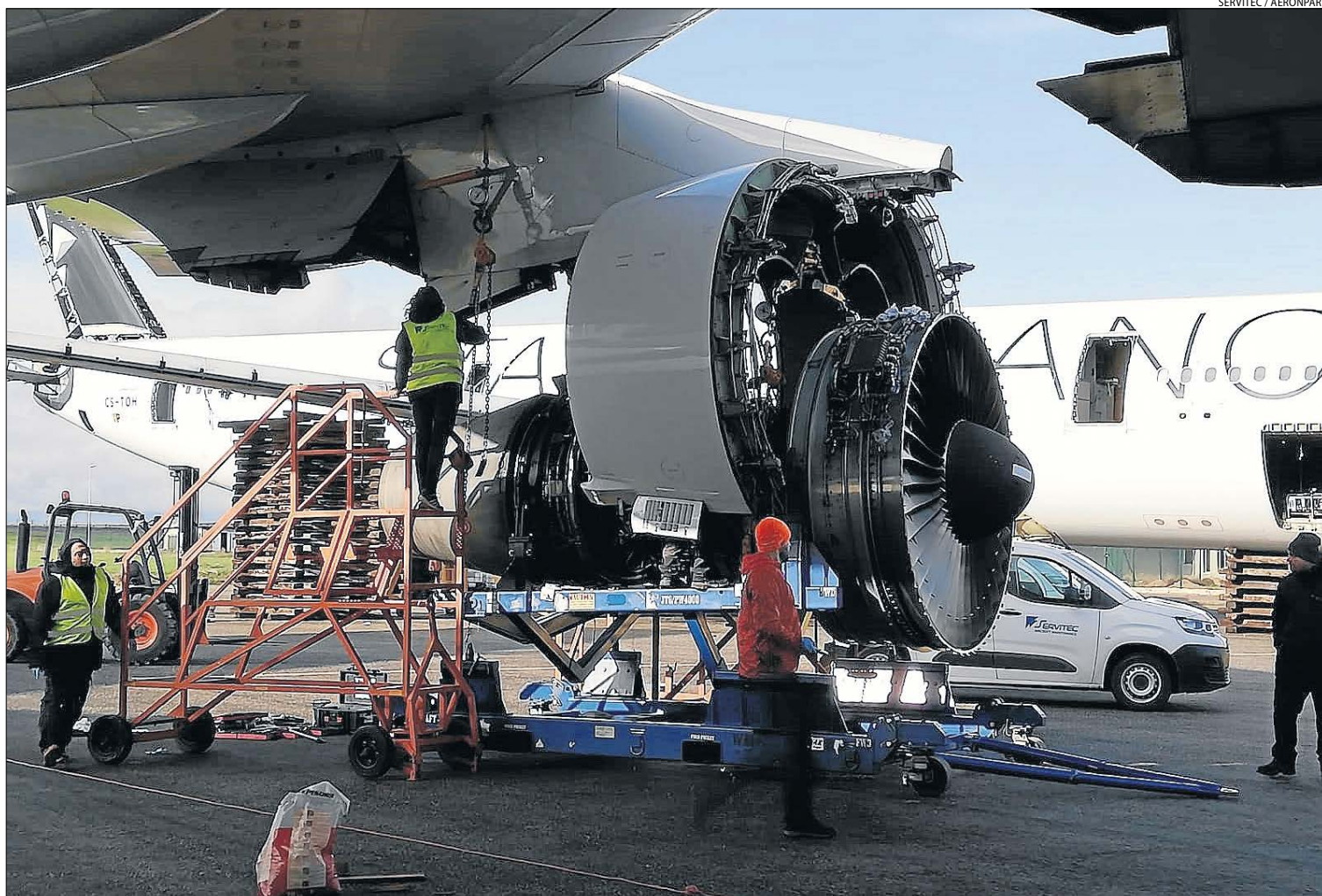
El Boeing 747-400 és el primer avió que es desballesta peça per peça a Alguaire per a reciclatge.
