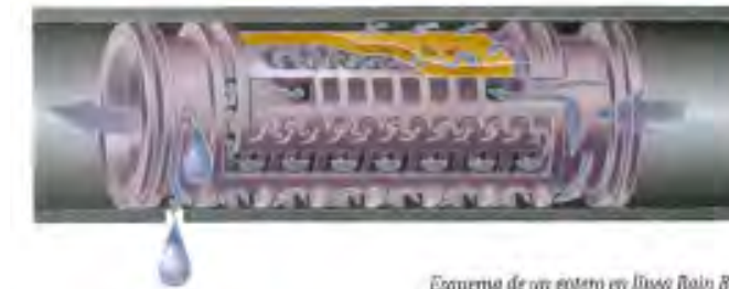
Esquema de un gotero en línea Rain Bird
